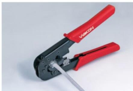
Figura 2.24. Forma correcta de crimpar cable UTP.
