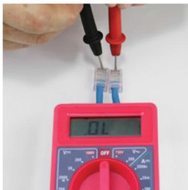
Figura 2.25. Comprobación del cable Ethernet.
