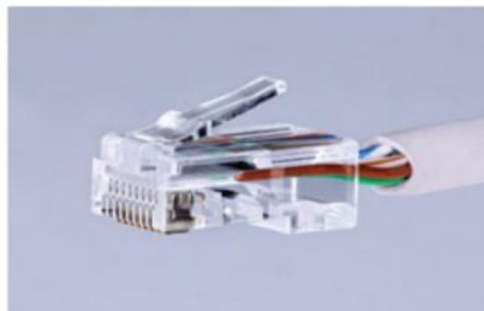
Figura 2.22 Forma incorrecta del cable.
